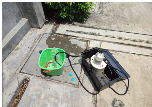
ภาพที่ 10-9 ฝาบ่อตรวจสอบคุณภาพน้ำทิ้งเป็นฝาคอนกรีต และเก็บตัวอย่างตรวจสอบคุณภาพน้ำทิ้งด้วยวิธี Grab Sampling ทุกเดือน
